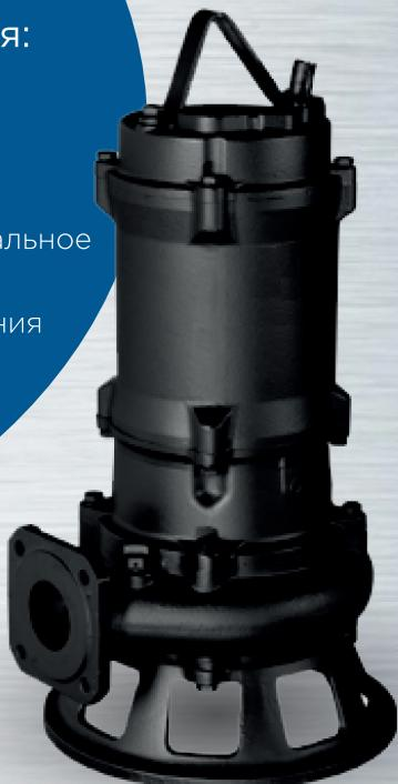
Погружные канализационные электронасосы серии JETEX F представляют собой вертикальные центробежные моноблоковые электронасосы, предназначенные для перекачивания, дренажных, сточных не очищенных вод, производственных сточных масс, фекальных и других неагрессивных жидкостей. Варианты установки: сухая и погружная.
